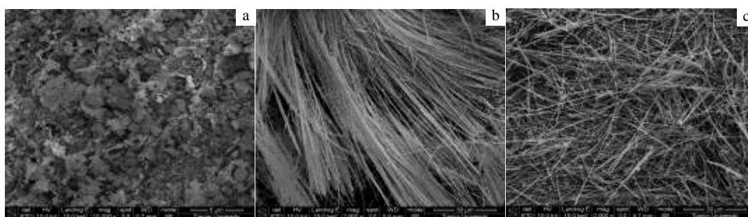
图 1 不同镁离子浓度产品的 SEM 照片
