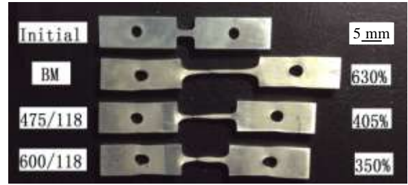
图 4 拉伸试样宏观形貌
