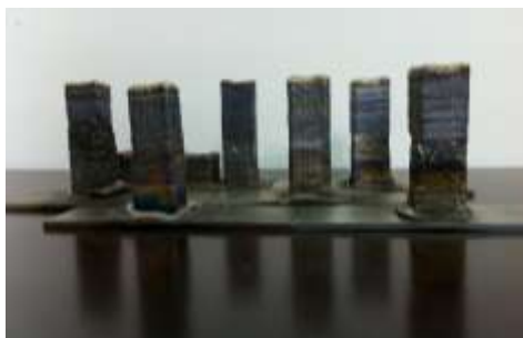
图 2 激光立体成形 Ti 3 Al/TC11 试样的宏观形貌 (上→下: Ti 3 Al → TC11)
