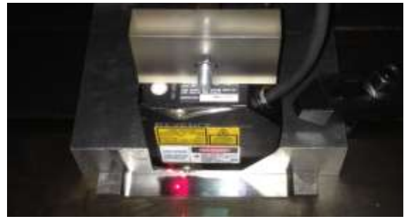
图 5 利用激光位移传感器测量零件的挠度
