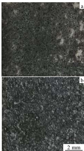
图 6 不同热处理下合金的剥落腐蚀形貌
