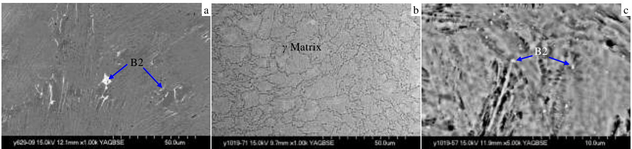
图 2 Ti-48Al-4Cr 合金的凝固组织
