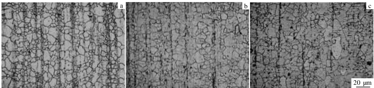
图 2 挤压合金的金相显微组织
