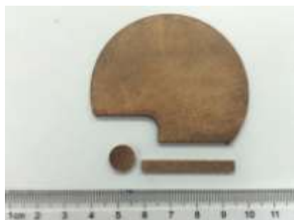
图 2 热等静压制得铜金刚石复合材料的样品图
