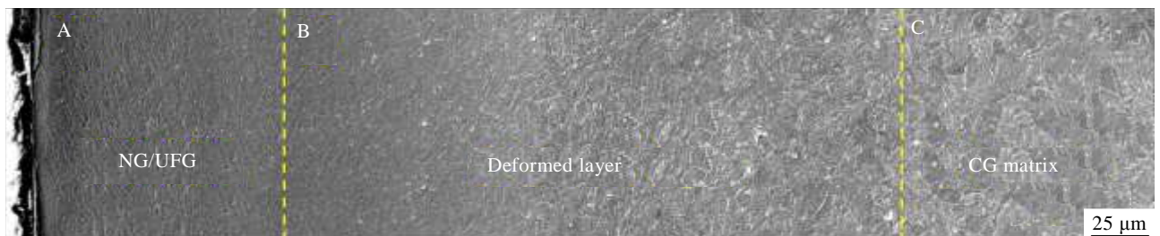
图 4 Zr-4 合金经表面滚压处理（8 道次，每道次滚压深度为 40 μm）后的横截面 SEM 组织
