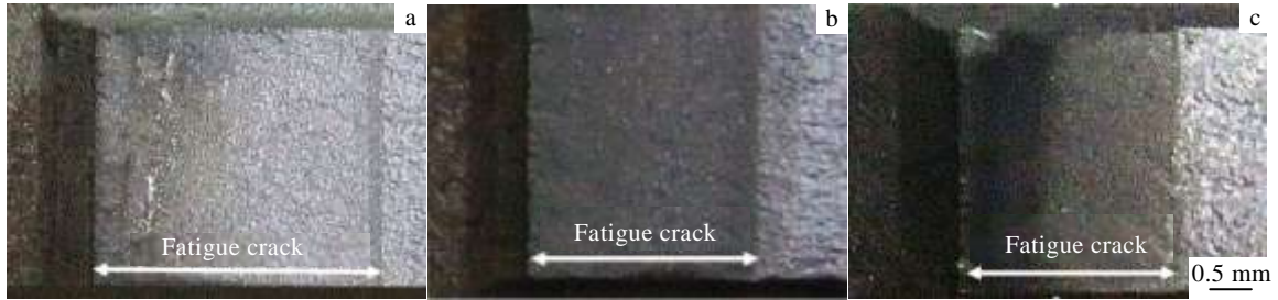
图 6 试样断面光学形貌 (裂纹从左向右扩展)
