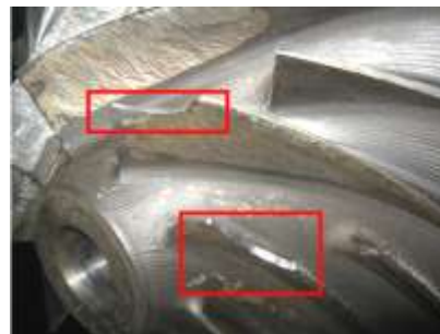
图 8 体积损伤叶轮叶片再制造成形前整体形貌
