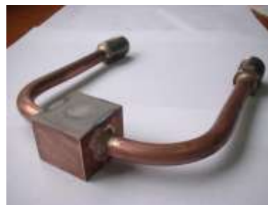
图 2 直接水冷等离子体喷涂 W/Cu 样品 (W0)
