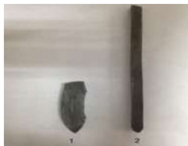
图 2 室温 ECAP 及 ECAP+CR 变形后的试样
