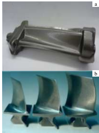
图 3 PW1134G 发动机的低压涡轮 3 级锻造叶片及 E3E 发动机的高压压气机 7、8、9 级锻造叶片
