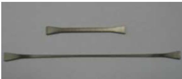
图3 在 1500 °C, 初始应变速率为 2.31 \times 10^{-4} \text{ s}^{-1} 变形前后的试样
