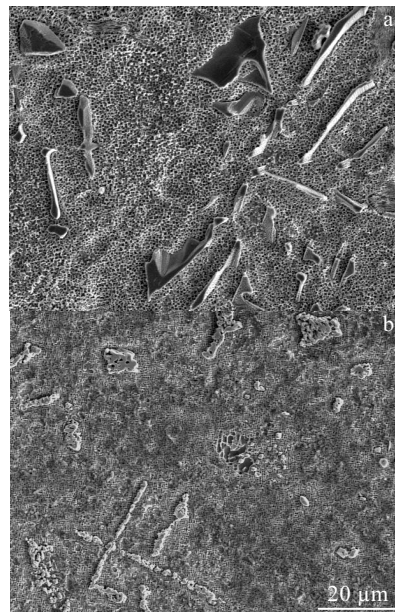
图 3 铸态 DZ125 合金中碳化物形貌
