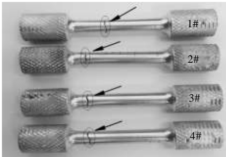
图 8 沉积修复件拉伸试样照片
