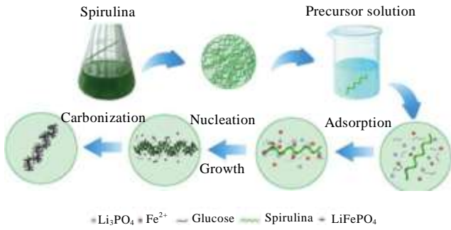
图 3 天然螺旋藻为模板制备多孔 LiFePO 4 合成示意图
