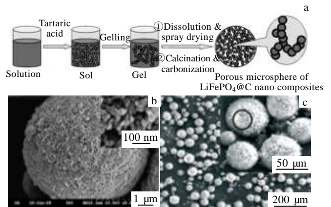
图 7 sol-gel-SD 合成多孔球形 \text{LiFePO}_4 示意图和形貌以及超临界喷雾干燥法制备的多孔球形 \text{LiFePO}_4 形貌
