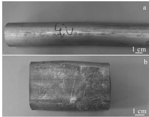
图 1 塑性变形加工前后的试样对比照片
