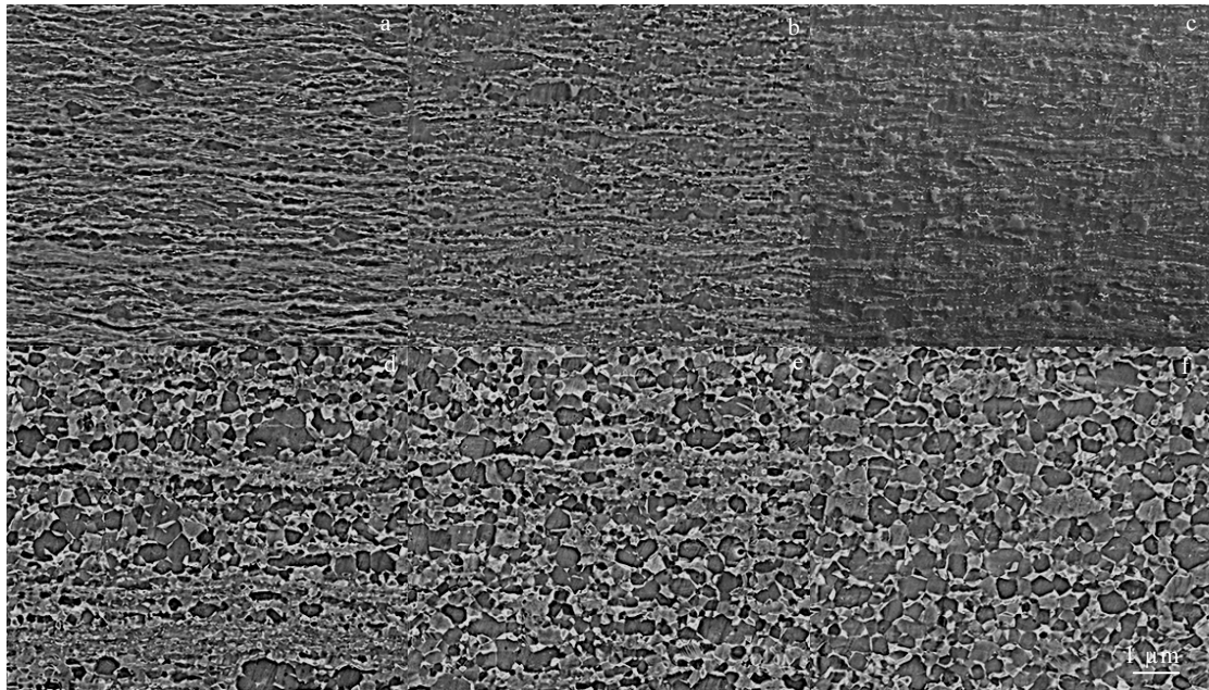
图 8 TC4 合金累积叠轧板材在不同热处理温度下的组织演化
