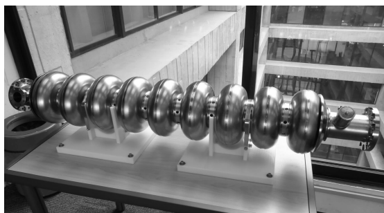
图 1 9 单元高纯铌射频超导腔
