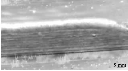
图 4 单壁墙成型试样
