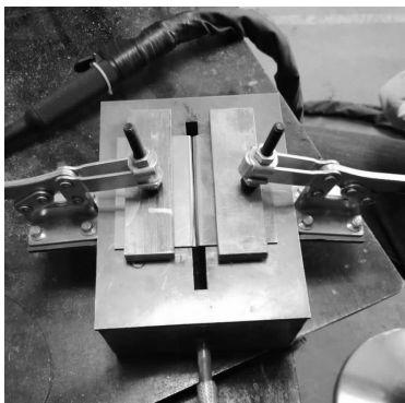
图 1 焊接示意图及夹具
