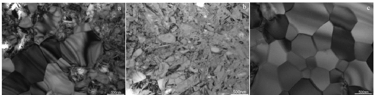
图 12 720 °C×30 h 热处理 TiNi/Ti 2 Ni 界面的 TEM 照片
