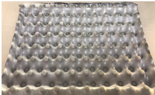
图 2 真空热蠕变成形后的 TC4 钛合金仿莲房特征芯体
