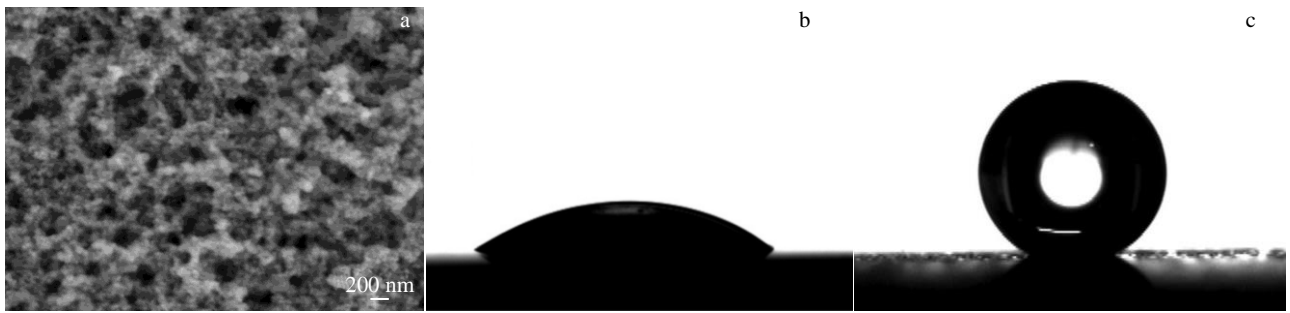
图 3 盐酸处理后 Ce_{65}Al_{10}Cu_{20}Co_5 块体非晶合金的表面形貌以及原始表面和改性后表面的接触角照片
