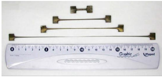
图 8 Ce 69 Al 10 Cu 20 Co 1 块体非晶合金的原始试样和不同变形量拉伸后的试样
