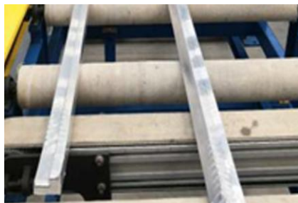
图 10 实验挤出的型材制品
