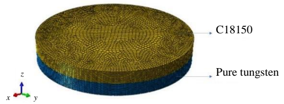
图 2 钨-铜试样有限元模型
