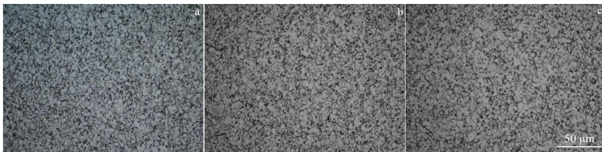
图 7 变形温度 1100 °C 时不同应变速率试样芯部显微组织
