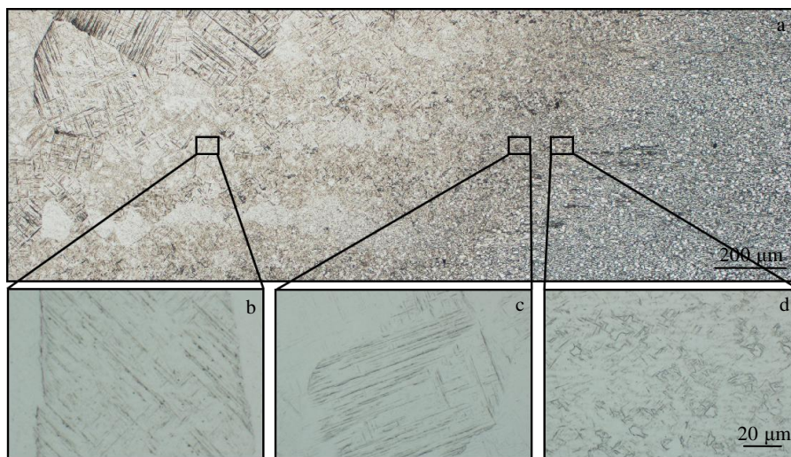
图 6 激光填实心焊丝焊接接头微观组织形貌
