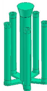
图 8 薄壁管铸件示意图
