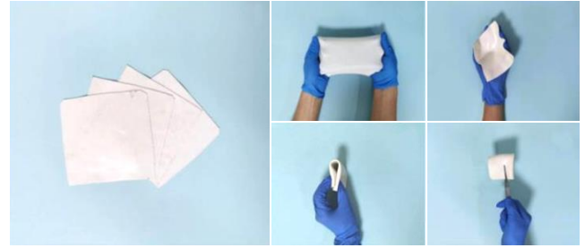
图 2 Gd_2O_3/SEBS 柔性材料实物图
