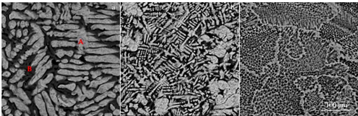
图3 W-10Ni, W-20Ni, W-40Ni 的微观结构
