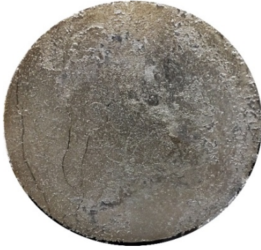
图 2 TC17 钛合金铸锭尾部冷隔
