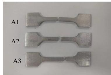
图 9 检测后的拉伸试样
