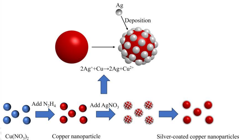
图 8 纳米银包铜粉的镀层形成机理 [50]
