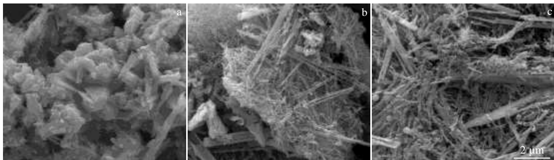
图 2 添加不同表面活性剂所制备的 Co 2 P 的 SEM 照片
