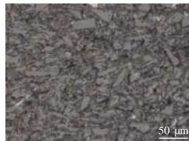
图 1 60vol% SiC p /6063Al 复合材料的金相照片 Fig.1 Metallograph of 60vol%SiC p /6063Al composites
