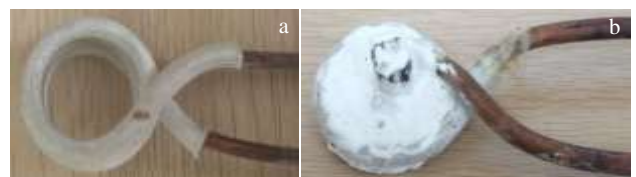
图 6 常规感应线圈（未经过改进）和经改进的感应线圈
