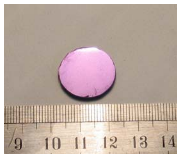
图 1 50 MPa 下 1250 °C 不保温烧结 LaB 6 试样照片
