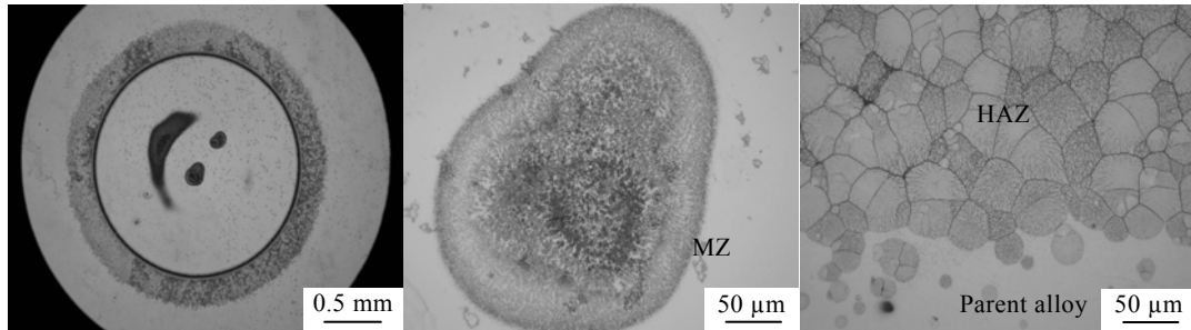
图 1 合金重熔时间为 0.5 s 的金相组织
