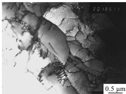
图 2 Ti40 合金在 1050\text{ }^{\circ}\text{C} , 0.01\text{ s}^{-1} , 变形量 70% 时的亚晶 Fig.2 Sub-grains in Ti40 alloy, occurring at 1050\text{ }^{\circ}\text{C} , 0.01\text{ s}^{-1} , \varepsilon=70\%
