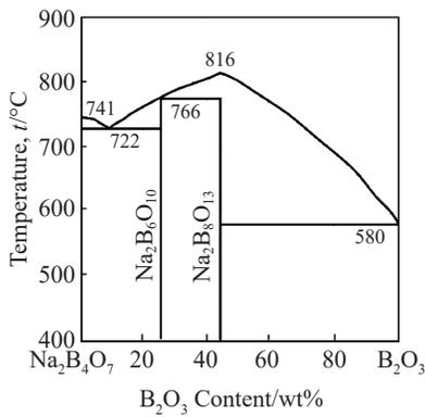
Fig.7  $Na_2B_4O_7-B_2O_3$  binary phase diagram
