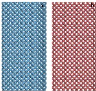
图 4 常规 Gyroid 单元多孔结构
