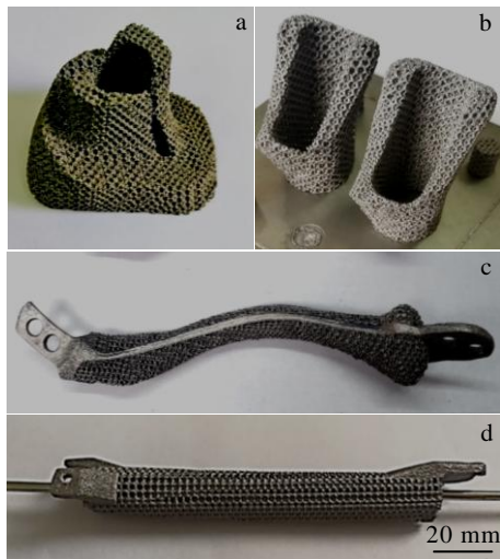
图 7 增材制造技术制备的个性化多孔钽植入体
