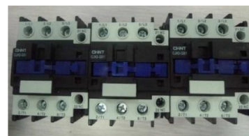
图 1 电寿命 AC-4 型式试验用交流接触器 CJX2-32
