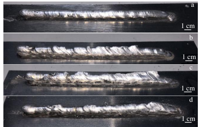
图 4 超声搅拌 WAAM 增材层宏观形貌
