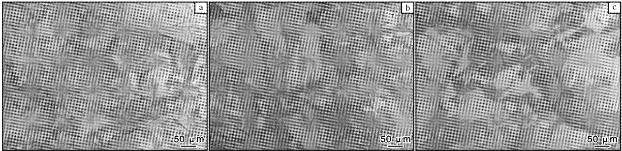
图 6 高氧 TC4 钛合金经不同温度加热后的微观组织
