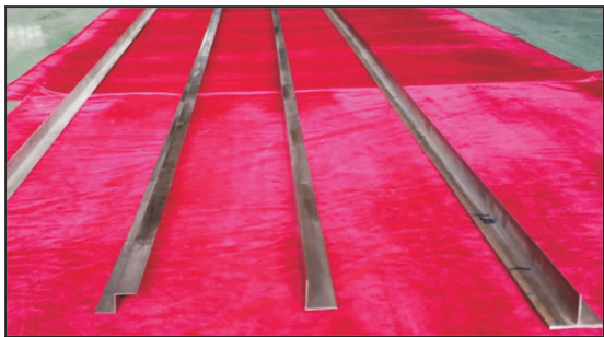
图 1 不同截面 TA15 钛合金热挤压薄壁型材
