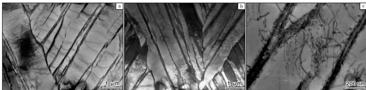
图4 TC4钛合金丝材片层组织的TEM照片
